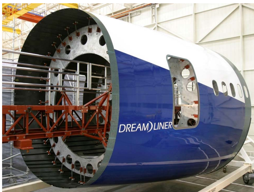
Рис 3. Конструкция фюзеляжа самолета Boeing 787 Dreamliner
