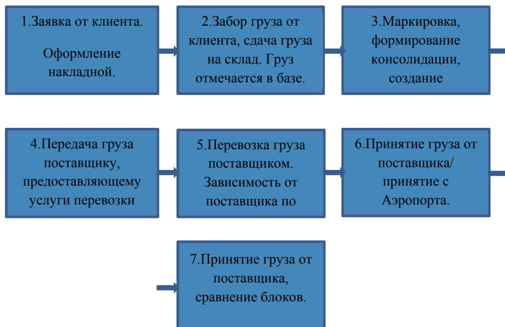
Рисунок 3 – Жизненный цикл груза при перевозке авто и авиатранспортом
