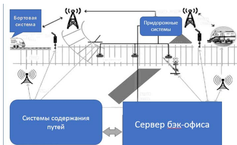
Рисунок 2 - Схема работы цифровой железнодорожной сигнализации.
