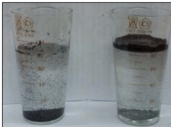
Рисунок 5 – Сравнение плавучести природного графита марки ГЛ-1 (а) и ТРГ (б)
