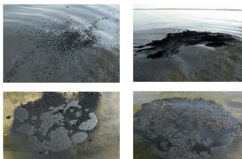
Рисунок 2 - Использование термографенита в промышленных условиях для ликвидации разливов нефти.
