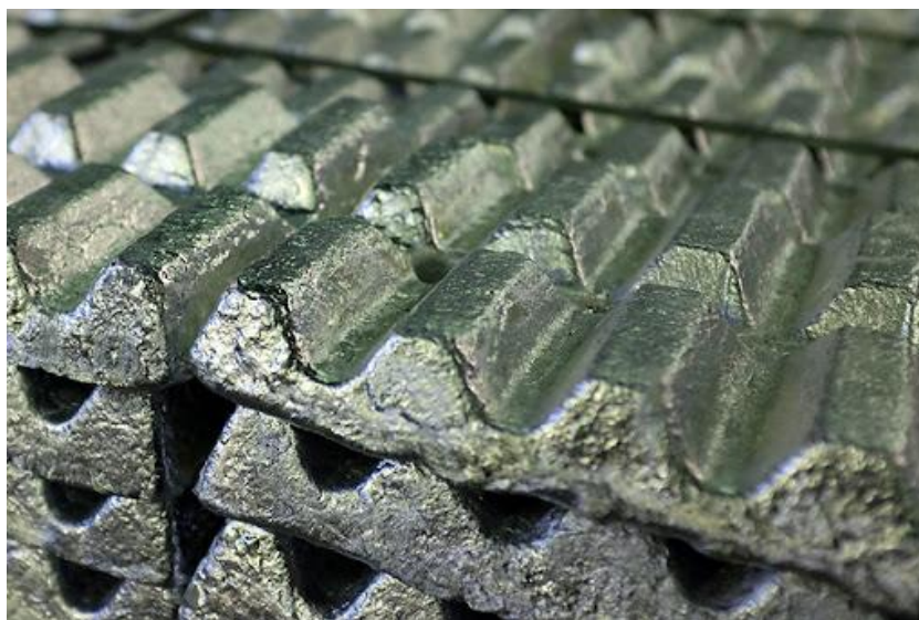
Рисунок 1. Литейный алюминиевый сплав - АК12(АЛ2).
