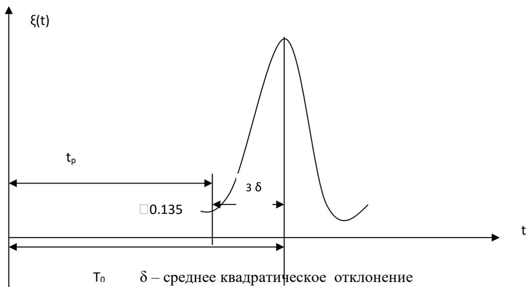
График определения межремонтного ресурса агрегата ( $t_p$ ) технического состояния каждого из них, не исключает возможности появления отказов и приводит к преждевременной замене или ремонту большей части агрегатов систем ЛА.
