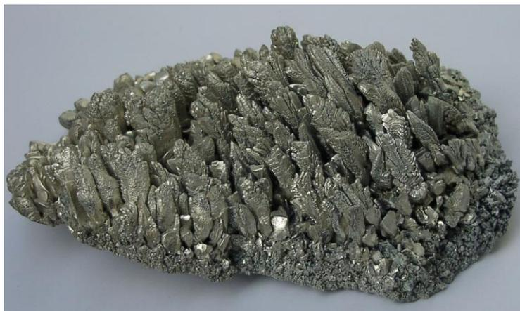
Рисунок 1. Внешний вид металла (магний).
