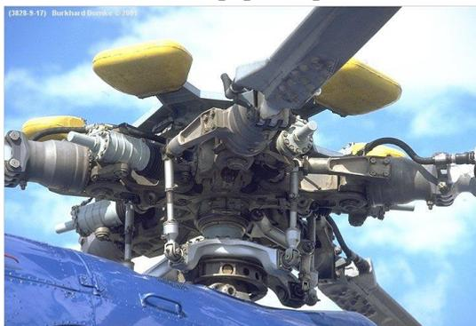
Рис. 4 Расположение демпферов лопастей
