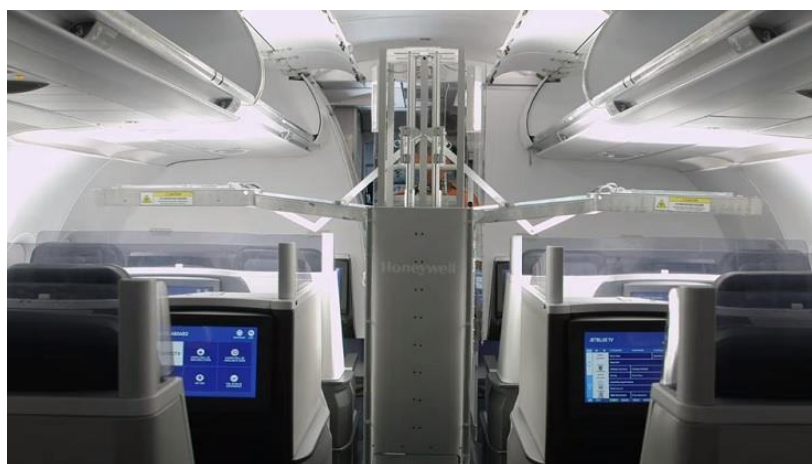
Рисунок 2 - Робот Honeywell для дезинфекции салона самолета
