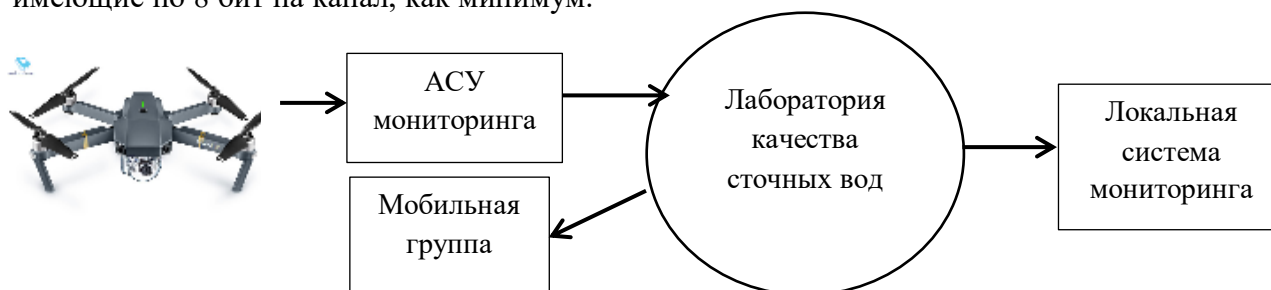
Рис. 2. Блок схема импактного мониторинга с БПЛА.
