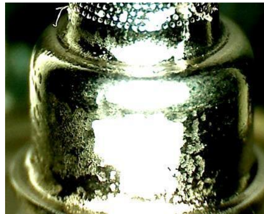
Рис.5 Продукты изнашивания деталей ТНВД, застрявшие в сетке фильтра регулятора давления
